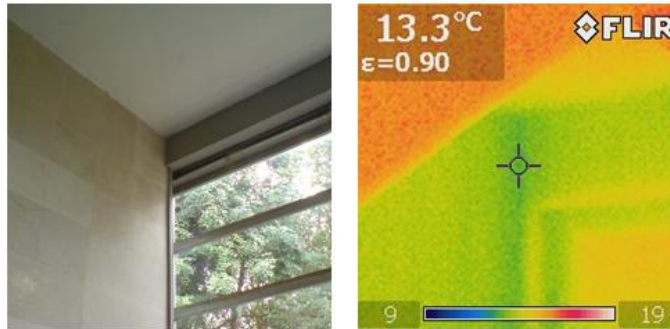
Εικόνα 4.32 : Παράδειγμα διείσδυσης αέρα και θερμικών απωλειών από κουφώματα
