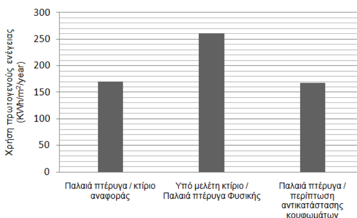
Εικόνα 5.20: Χρήση πρωτογενούς ενέργειας παλαιάς πτέρυγας πριν και μετά την αντικατάσταση όλων των κουφωμάτων
