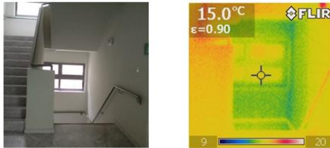
Εικόνα 4.46 : Παράδειγμα θερμικών απωλειών λόγω επικοινωνίας θερμαινόμενων χώρων με μη θερμαινόμενους
